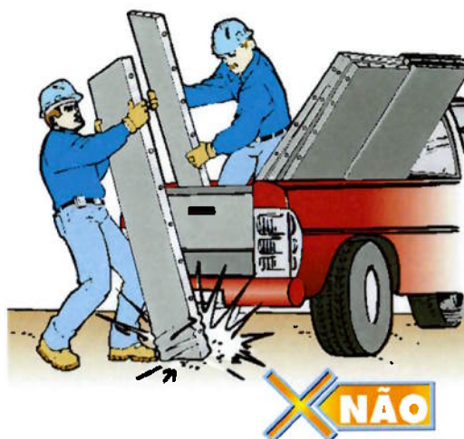
Figura 40 – Descarga inadequada das peças (fonte: catálogo técnico FORSA)
