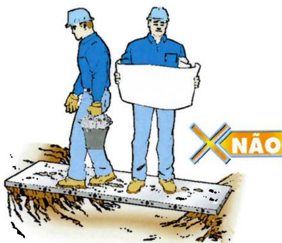
Figuras 38 e 39 – Soluções não recomendadas para caminhos no canteiro, pois não atendem aos requisitos de segurança da NR-18, item 18.12.6. (fonte: catálogo técnico FORSA)
