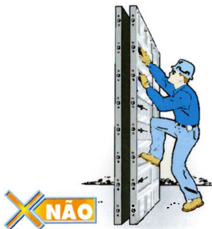
Figura 41 – Proibido utilizar esse acesso (fonte: catálogo técnico FORSA)
